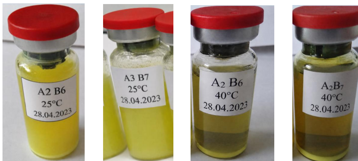
Рисунок 3.2 – Результати дослідження стабільності: справа наліво: 7 день випав осад (A2B6), 28 день випав осад (A3B7), 7 день випав осад (A2B6), 14 день випав осад (A2B7)
