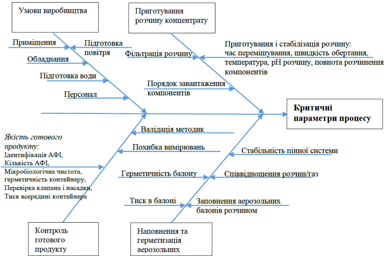
Рис.4.11 – Діаграма Ісікави, що ілюструє фактори ризику, які можуть вплинути на показники якості піни нашкірної з DOXH та DP.
