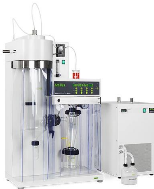
Рисунок 2.2 – Зовнішній вигляд експериментальної установки для виготовлення ТДС методом розпилювального сушіння
