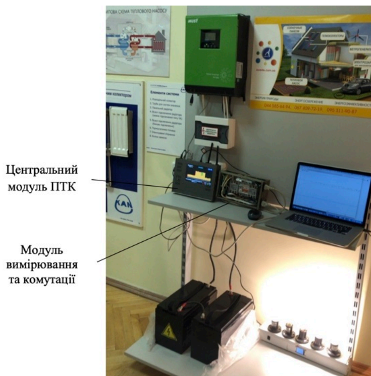
Рис. 4.7 Підключення ПТК під час випробувань в ЦЕ КНУТД
