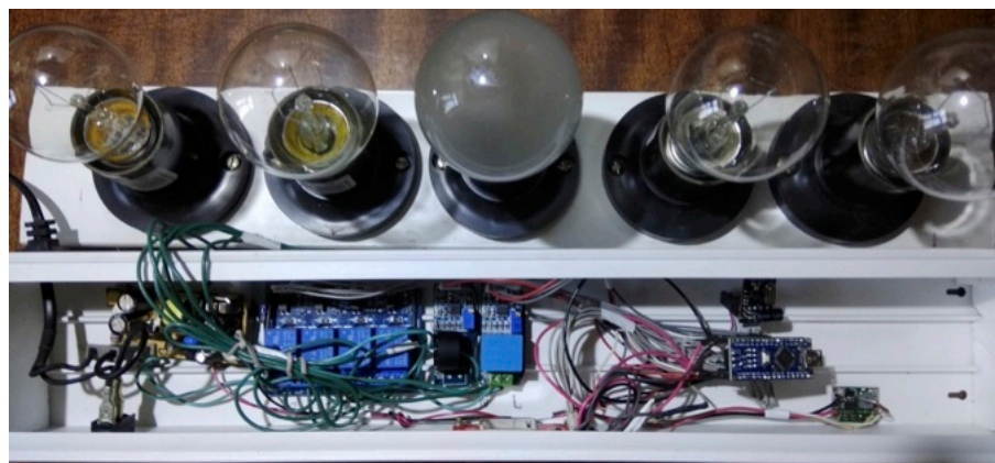
Рис. В.7. Конструкція керованого імітатора навантаження
