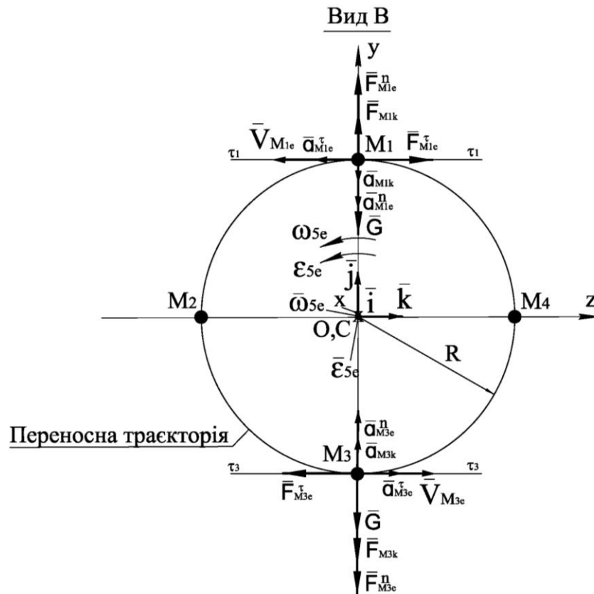
Рис. 2.18. Розрахункова схема для дослідження сил в площині Ouz при вертикальному розташуванні точки M у переносному русі
