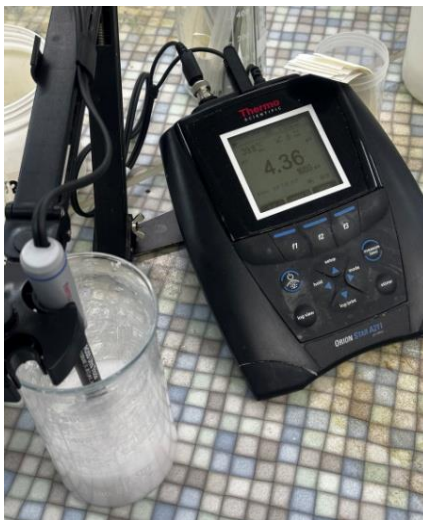
Рисунок 2.1 – Вимірювання значення рН напівготової суміші
