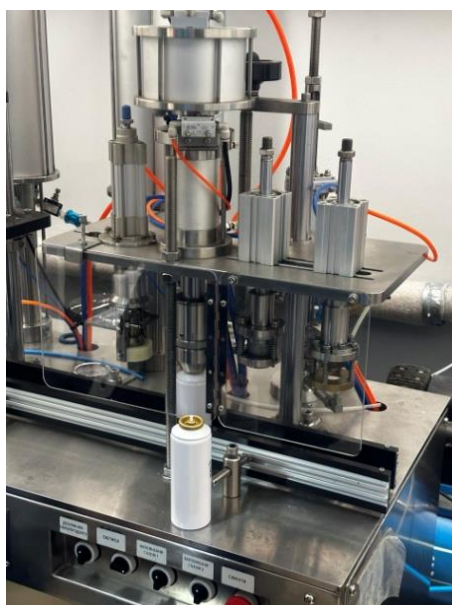
Рисунок 2.4 – Виготовлення аерозолю під тиском
