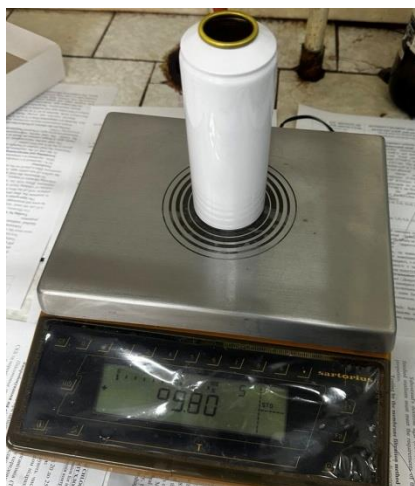
Рисунок 2.5 – Зважування порожнього контейнера
