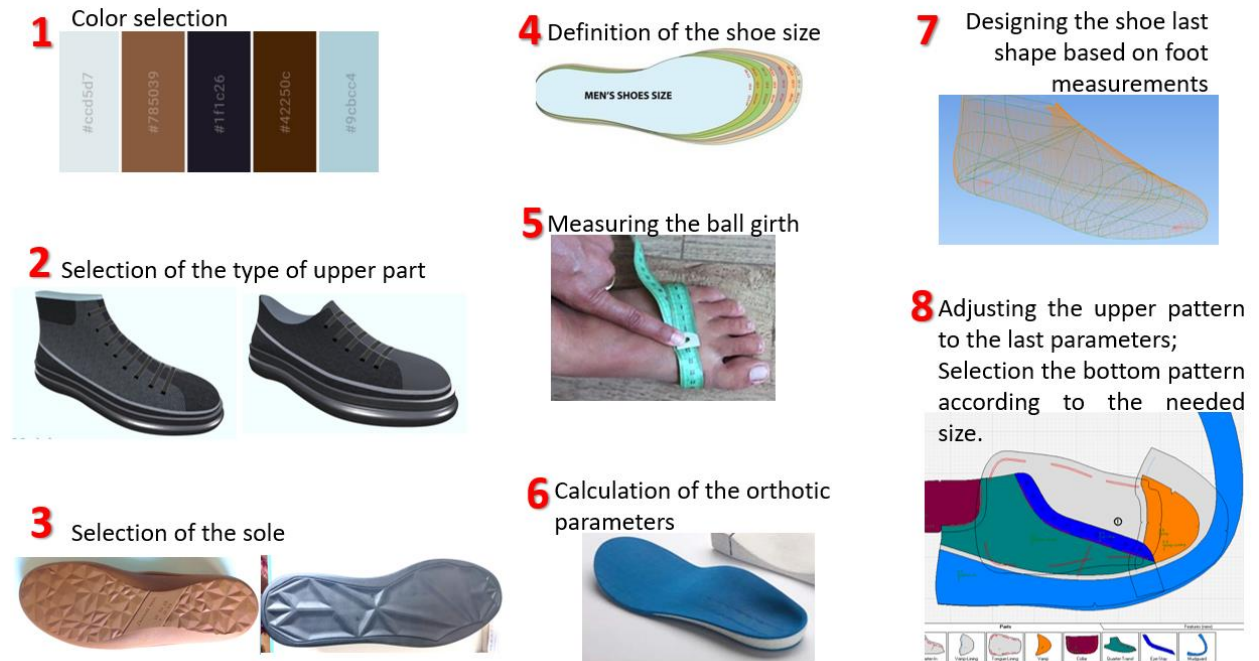
Рис. 5.20. Етапи виробництва індивідуального взуття.
