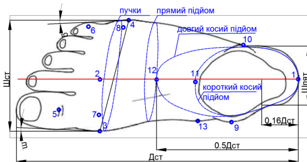
Рис. 3.3. Основні антропометричні орієнтири, що визначають параметри форми стопи.
