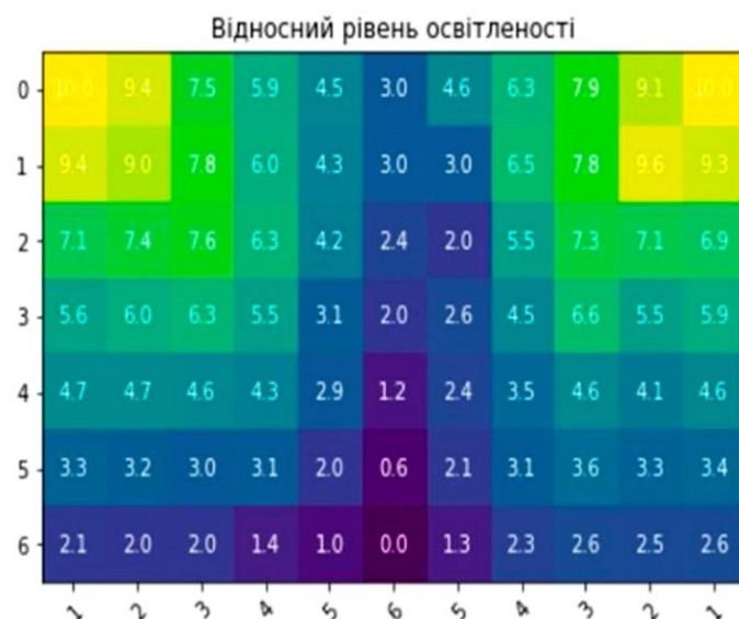
Рис. А.151. Приклад теплових карт: візуалізація рівня освітленості (у відносних показниках) [83]
