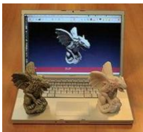
Рис. А.41. Приклад реплікації реального об'єкта за допомогою 3D-сканування та 3D-друку
