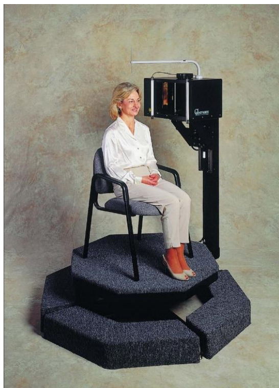
Рис. А.148. Cyberware Head & Face Color 3D Scanner та процес сканування [375]. Дві лампи встановлено на головці сканера для забезпечення якісного освітлення для отримання текстури
