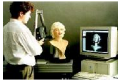
Рис. А.39. Тривимірний сканер із рукою та смугою з ручним керуванням [160]
