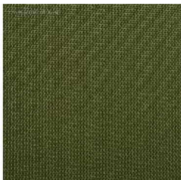
Рис. А.101. Високоактивний вуглецевий сорбційний волокнистий матеріал
