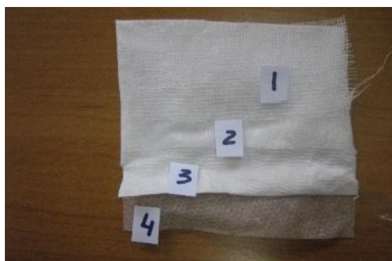
Рис. А.174. Заготовка для виготовлення півмасок: 1 – внутрішній шар; 2 – фільтр тонкого очищення; 3 – фільтр грубого очищення; 4 – зовнішній каркасний шар
