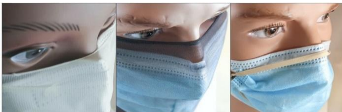
Рис. А.106. Ілюстрація фіт-хаків, що не змогли вирішити проблеми з підгонкою навколо перенісся; приклад функції, критичної для ефективності підгонки
