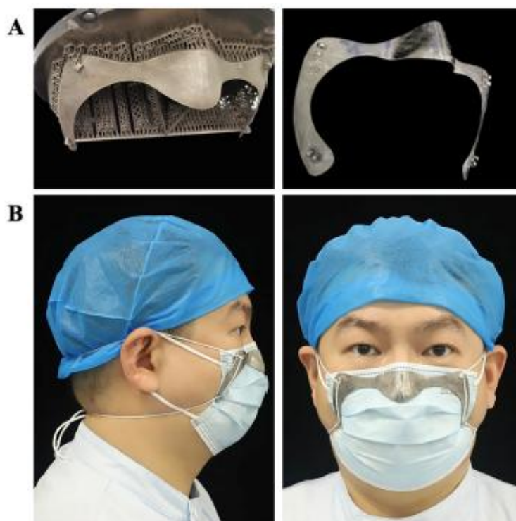
Рис. А.125. Фіксатор хірургічної маски: на панелі А показано виготовлення фіксатора за допомогою технології 3D-друку до та після видалення опори; на панелі В показано учасника в хірургічній масці з фіксатором
