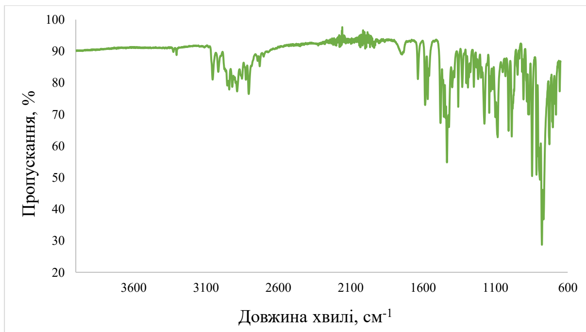
Рисунок 4.6 – FTIR-спектр фізичної суміші дезлоратадину з PLGA
