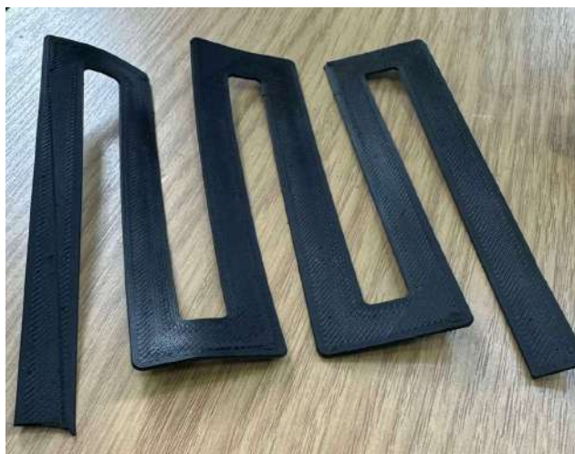
Рисунок 5.3. - Нагрівальний елемент для використання у літій-іонних елементах живлення
