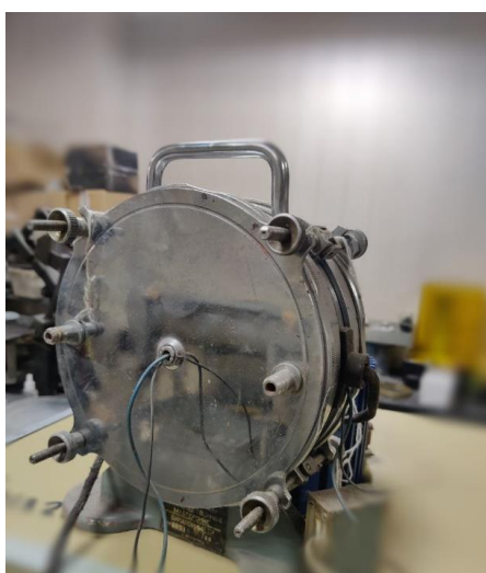
Рисунок 2.5 – Модернізований вимірювач теплопровідності зразків з монолітною та порожнистою структурою
