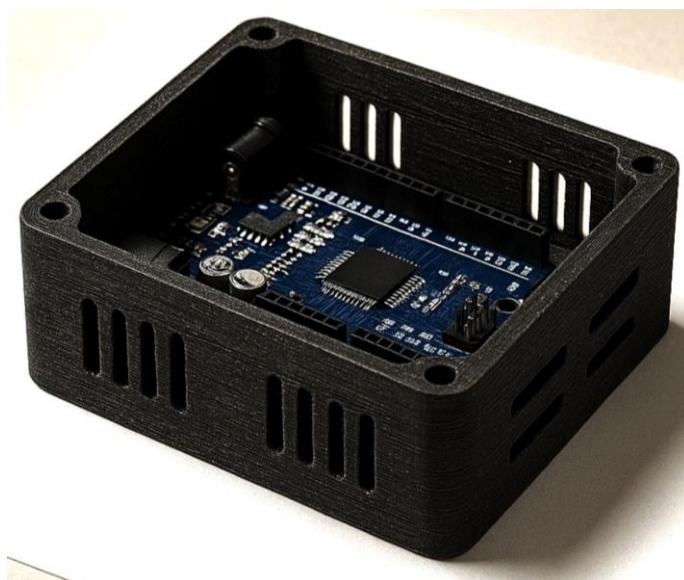
Рисунок 5.4 - Теплопровідний корпус багатфункціонального мікроконтролерного блоку локального керування
