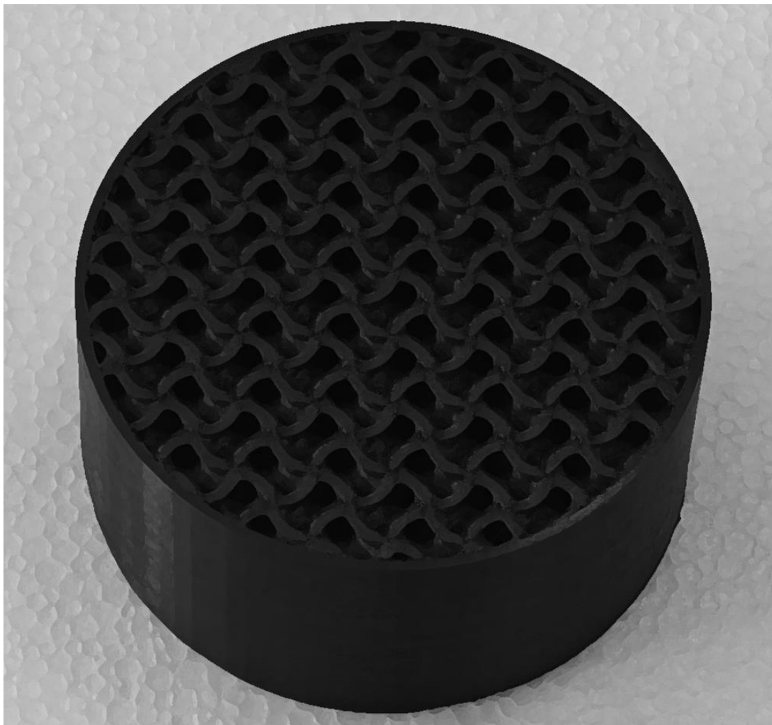
Рисунок 5.5 – Рекуператор, отриманий шляхом адитивного виробництва з композицій на основі PLA з 30% графіту та 20% оксиду титану
