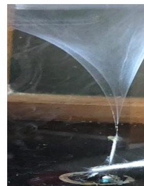
Рис. Нетканый волокнистый материал на основе ПВС с добавлением хитозану, розчиненого в молочній кислоті: а) мікрофотографія волокон; б) діаграма статистичного розподілу діаметрів волокон; в) процес розщеплення розчину з капіляру на волокна.
