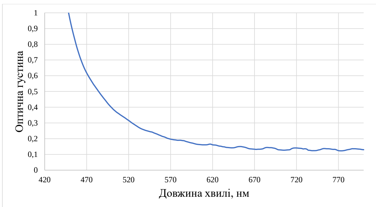
Рисунок 3.7 – Спектр оптичного поглинання розчину відцентрово сформованої полімерної ТДС на основі полівінілпіролідону та гесперидину (1%)
