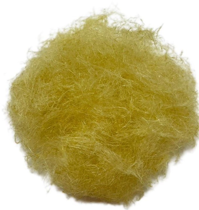
Рисунок 3.9 – Зовнішній вигляд утворених мікрОВОЛОКОН ТДС гесперидину SDS Hesp19 методом відцентрового формування волокон
