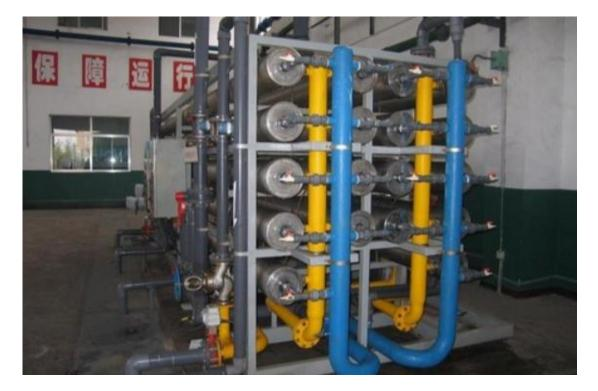
此设备能将残留有机溶剂和分子量小的物质过滤去除,保证产品中有机物质及副产物去除干净。
