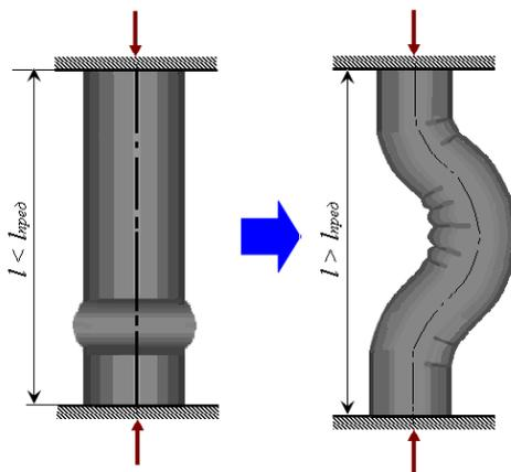
Рис. 3 Переход от потери устойчивости с образованием кольцевой складки к продольному изгибу
